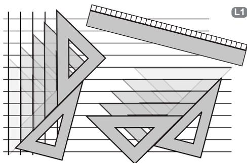
**Escuadra y cartabón:** Aunque no estaban permitidas inicialmente por las normas clásicas griegas ayudan mucho a ahorrar trazados auxiliares, a trazar ángulos de 15 en 15 grados y a trazar series de rectas paralelas o perpendiculares.
