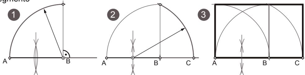
2º- Con centro en el punto medio del segmento y radio hasta el extremo superior de la perpendicular giramos la distancia sobre la prolongación del segmento AB hallando C.
