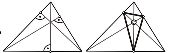
El triángulo Órtico, o triángulo podar órtico, de otro es aquel que surge de unir los pies de las alturas del primero. El incentro del triángulo órtico es el ortocentro del primero.
