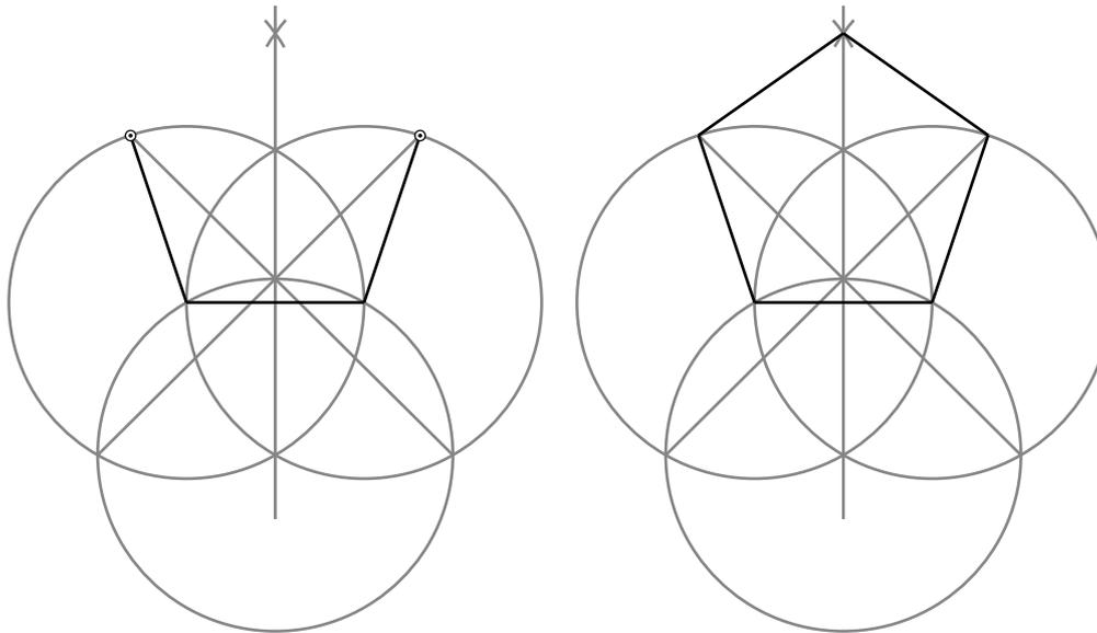
Los métodos que comunmente conocemos para la construcción exacta del pentágono regular, a partir de una circunferencia dada o a partir de su lado, emplean el método propuesto por Euclides para dividir un segmento en extrema y media razón (división áurea de un segmento o construcción de un rectángulo áureo).
