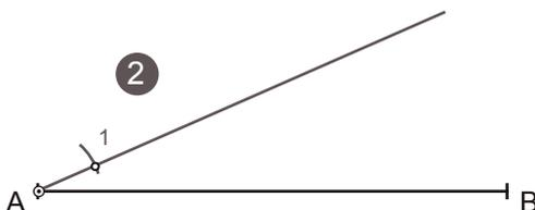
2º- Tomamos un radio de compás (no importa la abertura del compás, solo que quepa tantas veces como divisiones nos pide el problema sobre la recta auxiliar) y con centro en el vértice del ángulo trazamos una marca sobre la recta auxiliar.
