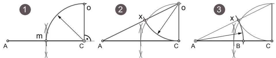
2º- Con centro en el punto (o) y radio oC giramos la distancia sobre el segmento Ao, obtenemos x.
