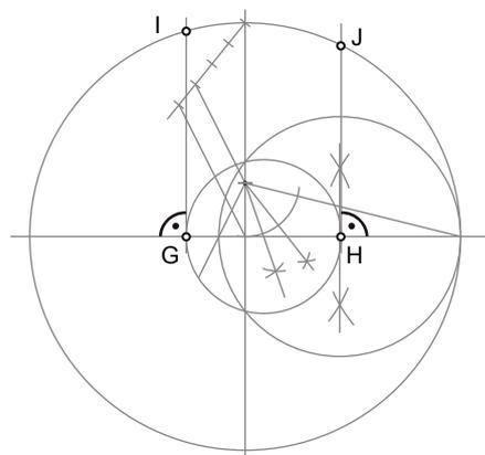
5º- Trazamos dos perpendiculares al diámetro horizontal por G y por H, obteniendo I y J sobre la circunferencia.
