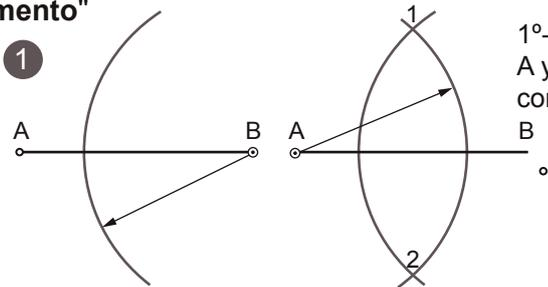
1º- Se trazan dos arcos de igual radio con centro en ambos extremos A y B. Se obtienen así los puntos 1 y 2 donde ambos arcos se cortan.
