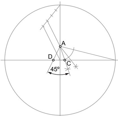
1º- Trazamos a la circunferencia dos diámetros perpendiculares entre sí. Estos contienen cuatro radios. Dividimos el radio vertical superior en 4 partes iguales. Unimos el punto que delimita el primer cuarto del radio, A, con el extremo del radio horizontal de la derecha, B, obteniendo un ángulo, el cual dividimos mediante dos bisectrices en cuatro partes iguales. La segunda bisectriz determina C sobre el diámetro horizontal.
