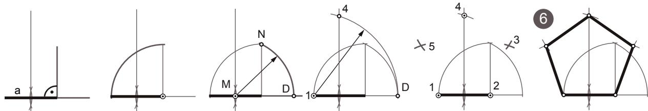
1º- Se traza la mediatriz del lado. Por el extremo derecho se levanta una perpendicular y se prolonga el lado.
