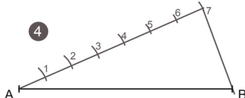
4º- Trazamos un segmento que une la ÚLTIMA DIVISIÓN de la recta auxiliar con EL EXTREMO B del segmento dado.
