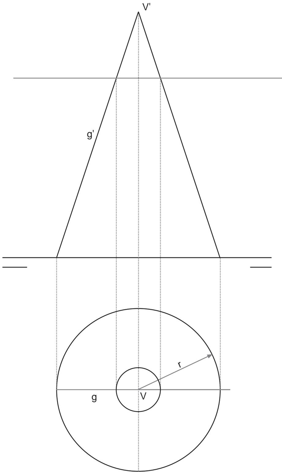
Seccionando un cono con un plano perpendicular al eje obtenemos una sección cuyo contorno es una circunferencia. En esta representación el cono ha sido seccionado por un plano paralelo al PH de proyección. La circunferencia en proyección horizontal ya se encuentra en verdadera magnitud y forma.
