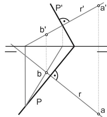
e) Trazar una recta R que pase por A y sea perpendicular al plano P. Determinar sus trazas y su visibilidad.
