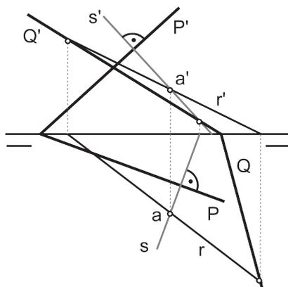
e) Determinar las trazas del plano P que contiene a los puntos A y B siendo perpendicular al plano Q dado.
