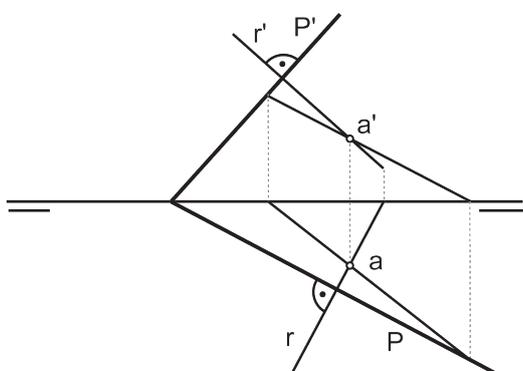
h) Determinar las trazas del plano P que contiene al punto A y que es perpendicular a la recta R dada.
