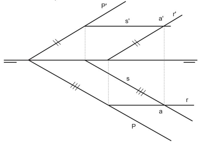
c) Dado el punto A, traza el plano T, paralelo al PV que lo contiene y el plano Q paralelo al PH que lo contiene:
