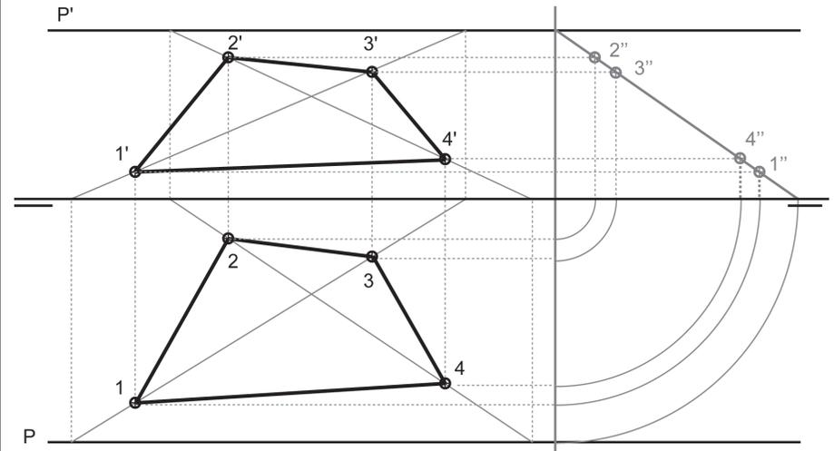
Podemos resolver este problema bien trazando las proyecciones verticales de rectas pertenecientes al cuadrilátero (lados o diagonales) que nos darán las trazas y las proyecciones horizontales, o bien trazando la tercera proyección del plano y proyectando sobre esta los puntos. Aquí mostramos los dos procedimientos.
