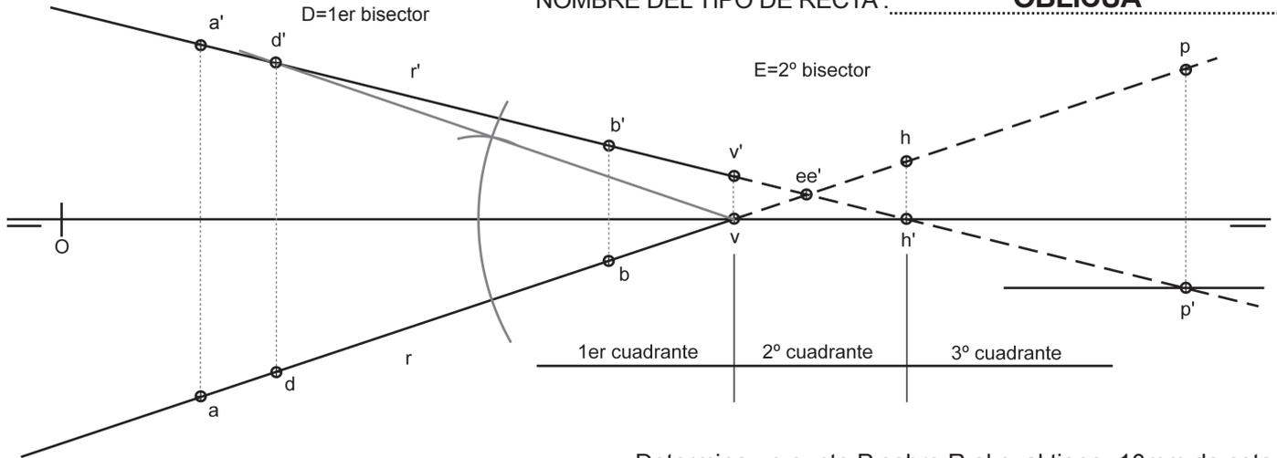
Determina un punto P sobre R el cual tiene -10mm de cota:
