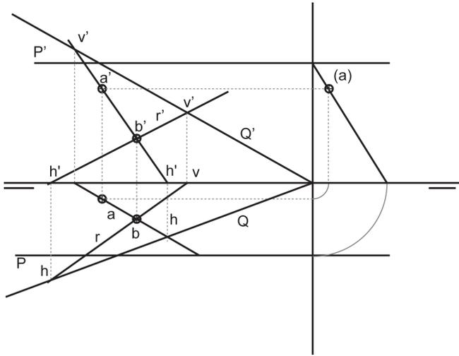
b) Determina el punto A contenido en el plano P que tiene 20 mm de cota y 10 mm de alejamiento.
