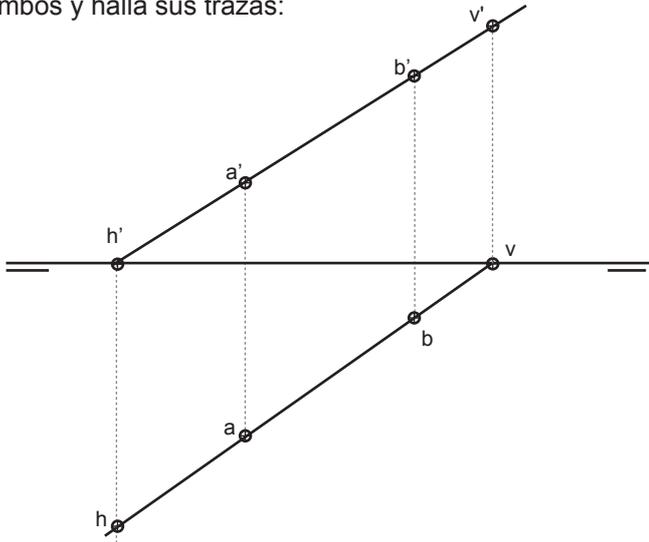
b) Determina las proyecciones de una recta horizontal, de cota 20 mm. determina también su traza, sabiendo que pasa por los puntos a y b. Determina las proyecciones verticales de a y b:
