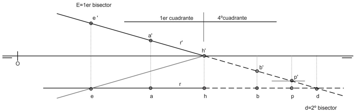
Determina un punto P sobre R el cual tiene -13mm de cota:
