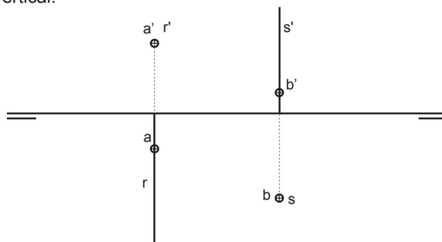
g) Dadas las proyecciones de la recta r, las de su traza vertical vv' y las proyecciones de un punto P (pp') perteneciente a ella; se pide hallar la traza horizontal hh' de la recta r
