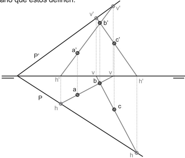
b) Dadas las rectas r y s que se cortan en el punto A, traza el plano Q que las contiene.
