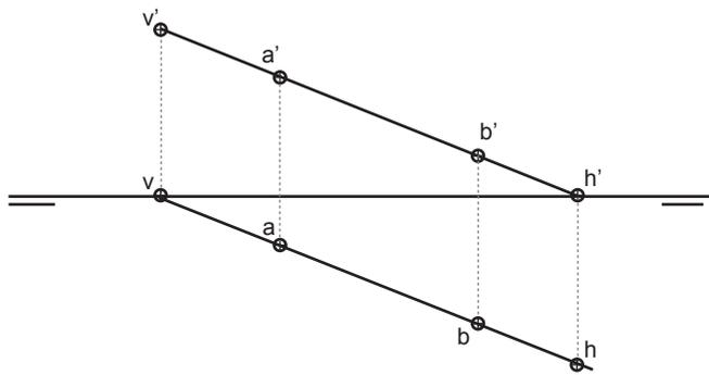
b) Dados los puntos A y B dibuja la recta que pasa por ambos y determina sus trazas:
